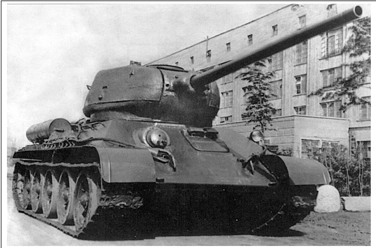
Figura 14. Modularidad en acción: un tanque T-34. La apuesta soviética por fabricar en serie sólo dos modelos de tanques evitó la proliferación de distintas piezas, no intercambiables, para los mismos cometidos.
