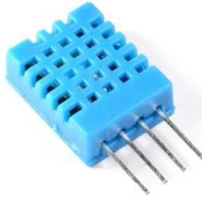
Figura 5.9: Sensor DHT11.
