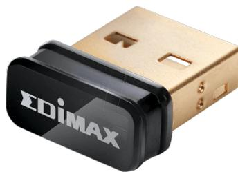
Figura 5.1: Adaptador USB WI-FI Edimax EW-7811UN.
